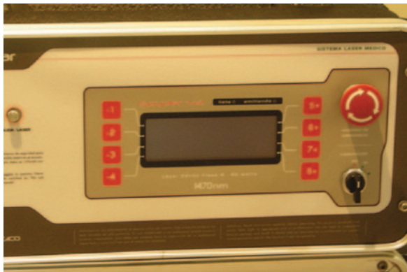
Equipo laser quirúrgico de 1470 nm.
